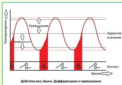
**Регулируемый дифференциал:** низкий дифференциал часто ассоциируется с точностью управления. Однако слишком низкий дифференциал вызовет короткие циклы нагрева и преждевременный износ контактов, если используется силовое реле, или быструю деградацию компрессора, если система используется для управления холодильником. Электронные регуляторы, представленные в этом каталоге, имеют регулируемый дифференциал для оптимизации этой операции.
