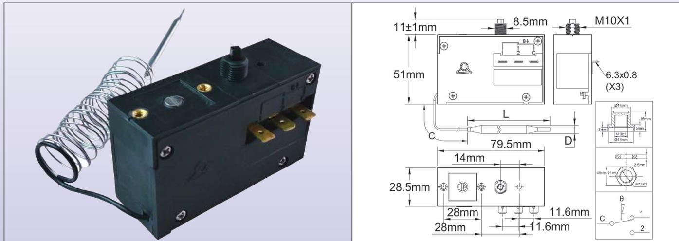
**Размеры корпуса:** 79,5 × 51 × 28,5 мм (быстроразъемные клеммы 6,3 и кнопка ручного сброса не включены)
