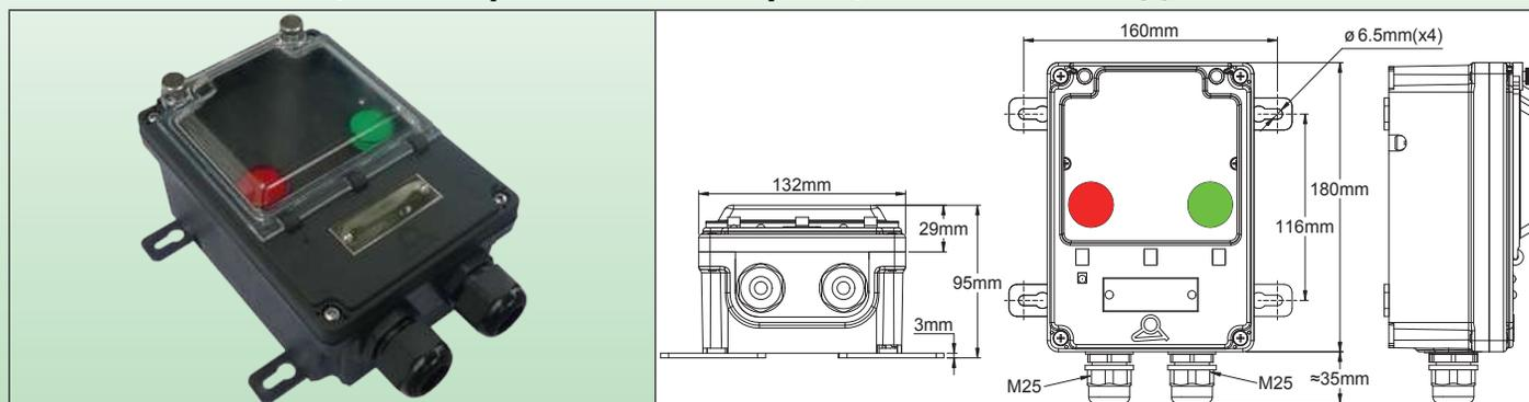
3 × 16A (AC1), 250 В, клеммная колодка с 5 клеммами под винты 2,5 мм<sup>2</sup> и 5 винтовыми клеммами 6 мм<sup>2</sup>. Красный индикатор питания и зеленый индикатор выхода (250 В), прозрачное окошко.
