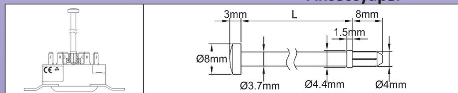
Стержни с ручным сбросом, работают на больших дистанциях
