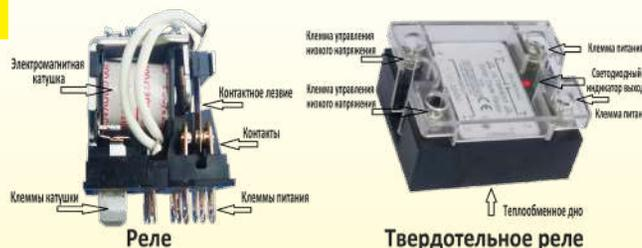
**Реле или электромеханический контактор:** катушка состоит из очень большого количества витков очень тонкой медной проволоки. Когда через катушку проходит достаточный ток, она создает магнитное поле, которое притягивает подвижную часть и перемещает герконы с электрическими контактами. Когда ток больше не течет в катушке, контакты возвращаются в исходное положение благодаря восстанавливающей пружине.
