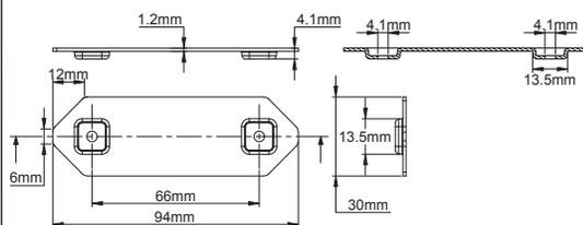
Для установки коробка бок о бок, оснащенного вентилятором с защитой от атмосферных воздействий, на другой короб тех же размеров
