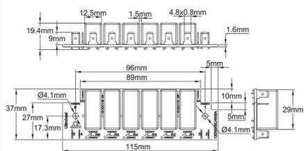
Электронная релейная плата, 6 реле 16А 250 В. Они выпускаются в вариантах от 4 до 6 реле с нормально разомкнутыми контактами. Катушки реле имеют индивидуальное питание, 220-240 В. Клеммы 4,8 × 0,8.
