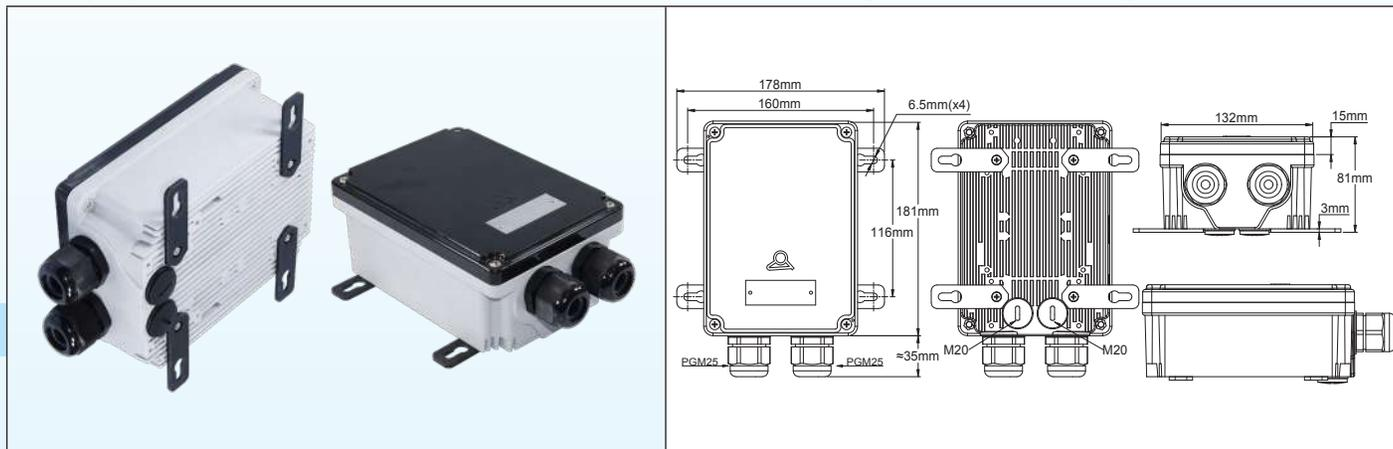
Эти герметичные алюминиевые коробки окрашены эпоксидной краской RAL 7015. Они имеют те же размеры, что и пластиковые блоки управления, и используют плоские крышки. В них используются те же выступы крепления к стене, что и в пластиковых моделях. Они были разработаны для установки одно- или трехфазных твердотельных реле, охлаждение которых осуществляется за счет ребер на задней панели.
