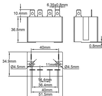
2 × 25 А 250 В резистивных (AC1) (CE и UL) нормально разомкнутого контакта, герметичный корпус, клеммы 6,35×0,8. Это реле может быть установлено без монтажной платы непосредственно на всех пластиковых срабатывающих поверхностях, предусмотренных для патронных и капиллярных термостатов и электронных контроллеров, а также на плоских поверхностях распределительных коробов, представленных в этом каталоге. Катушка 200-240 В перем. тока
