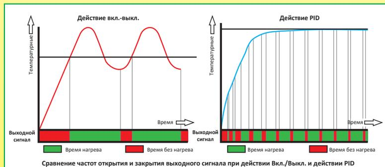
Если действие PID может улучшить управление в ряде конфигураций, то недостатком является то, что выходной сигнал будет циклически повторяться очень быстро, что сильно сокращает срок службы силового реле и требует в большинстве случаев использования твердотельных реле.
