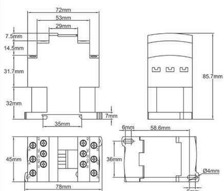
3 × 25А or 3 × 32А 250/400 В перем. тока рез. (AC1), винтовые клеммы, катушка 240 В перем. тока или 400 В. Соответствуют стандарту IEC947-1 (EN60947-1), но большая площадь ограничивает их применение внутри блоков управления. Он не подходит для типов Y8, но может использоваться в Y6 и Y7 с однополюсным термостатом.
