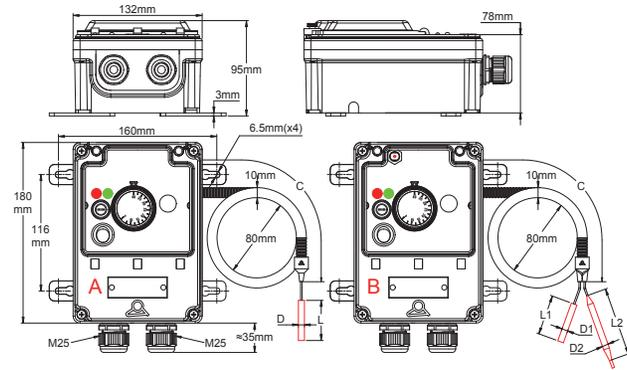
**A:** Модель с одним датчиком, только контроль температуры.
