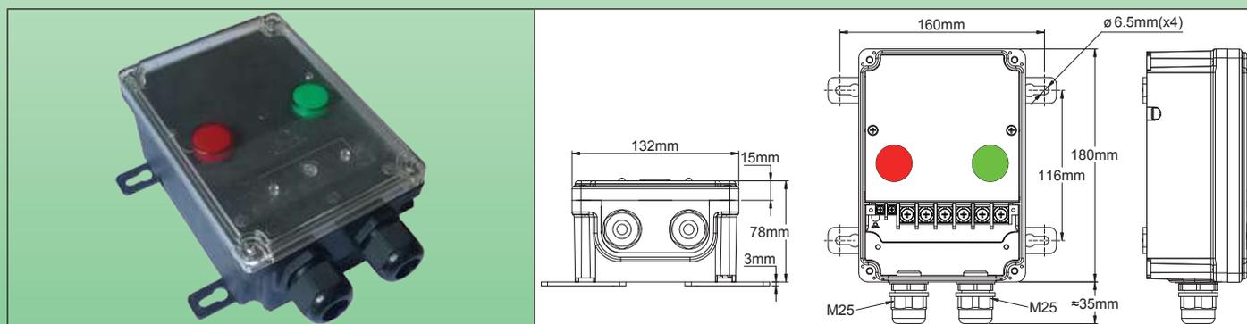
3 × 25 А (AC1), 250 В, клеммная колодка с 2 клеммами под винты 2,5 мм<sup>2</sup> и 6 винтовыми клеммами 10 мм<sup>2</sup>. Красный индикатор питания и зеленый индикатор выхода (250 В), прозрачная крышка.
