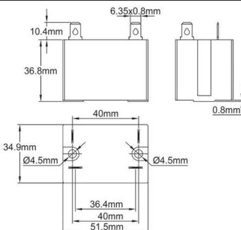
1 × 30 А 250 В резистивный (AC1) (CE и UL) нормально разомкнутый контакт, герметичный корпус, клеммы 6,35×0,8. Это реле может быть установлено без монтажной платы непосредственно на всех пластиковых срабатывающих поверхностях, предусмотренных для патронных и капиллярных термостатов и электронных контроллеров, а также на плоских поверхностях распределительных коробов, представленных в этом каталоге. Катушка 200-240 В перем. тока
