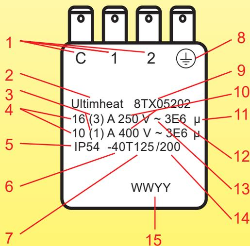
1: идентификация клемм, которые подходят для подключения внешних проводников, подходят ли они для линейных или нейтральных проводников, или для обоих.
